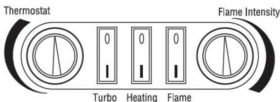
Las funciones de llama y calentamiento pueden activarse mediante los botones del programador portátil a control remoto.
