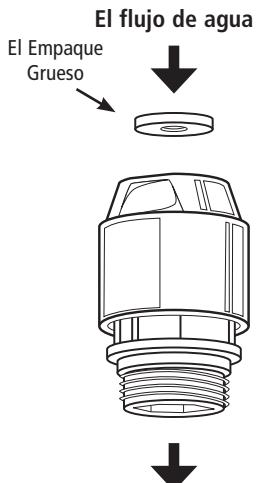
Para proteger la red de agua portante de una posible contaminación ocasionada por el agua de albercas, lavabos, tinas/regaderas o W.C., existen municipales que exigen el uso del anti-sifón. Este anti-sifón previene el regreso de agua por medio de un ajuste del diafragma controlado por la presión de la misma.
