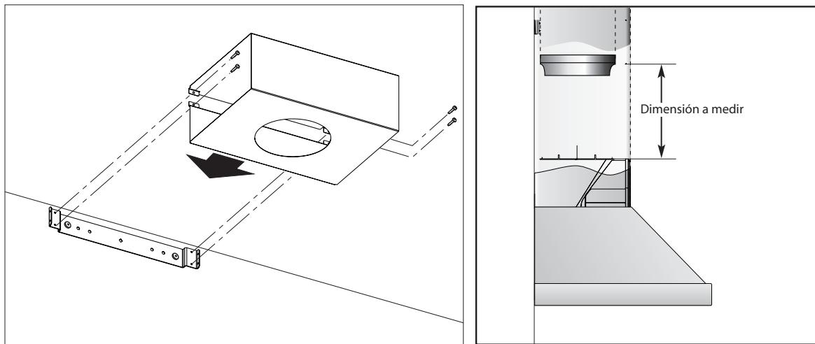
Corte el conducto según el tamaño medido
