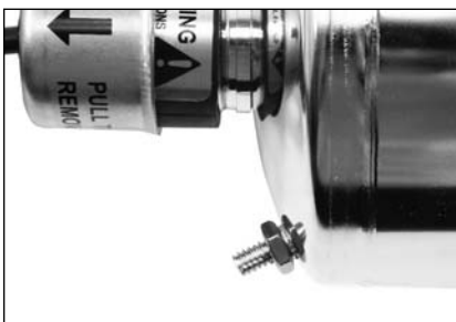
Step 14 - Install Nut on Stud
